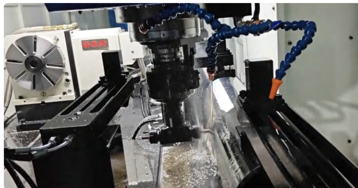
BT40-ER25-2X 双出角度头铣削 - 加工案例 / Example -
